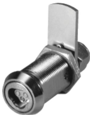
Замок CyberLock представляет собой электронную версию механического кулачкового щеколдного замка Double-D на 3/4". Корпус замка изготовлен из никелированной латуни, электронный модуль заключён в оболочку из никелированной стали, а щеколда выполнена из нержавеющей стали.
