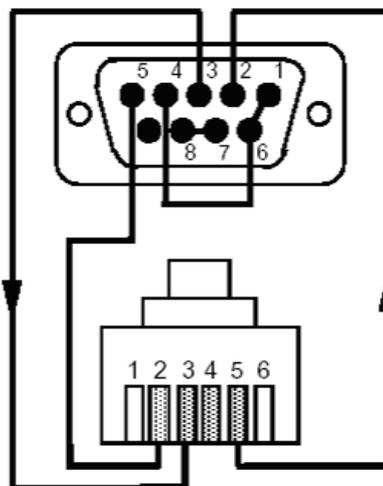
Вид со стороны разъёма RJ-11
