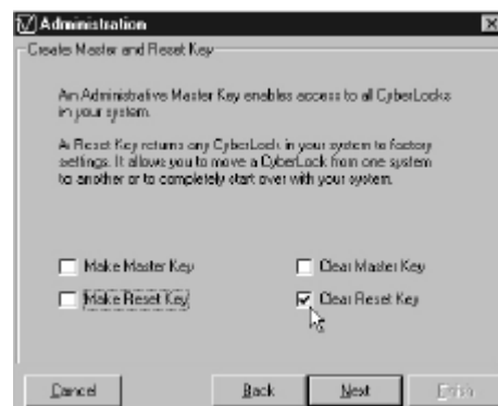
Рисунок 66 – очистка ключа сброса
